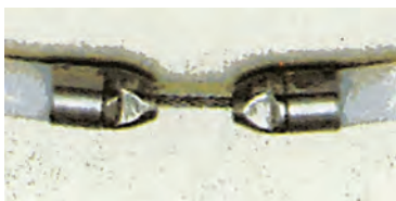
ΣΧ.8.4.7.2.α Ειδικός μηχανισμός αντικατάστασης πλαστικών σωλήνων.
